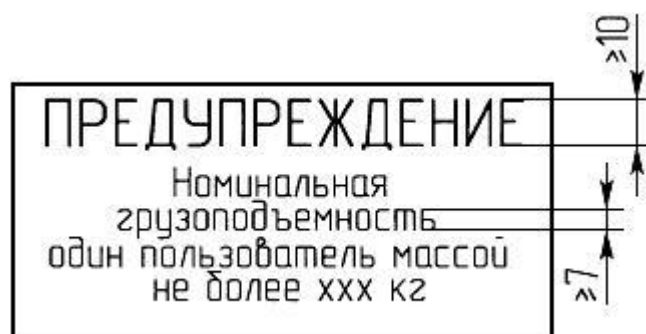
Рисунок 15 - Образец стандартной надписи с информацией о грузоподъемности
