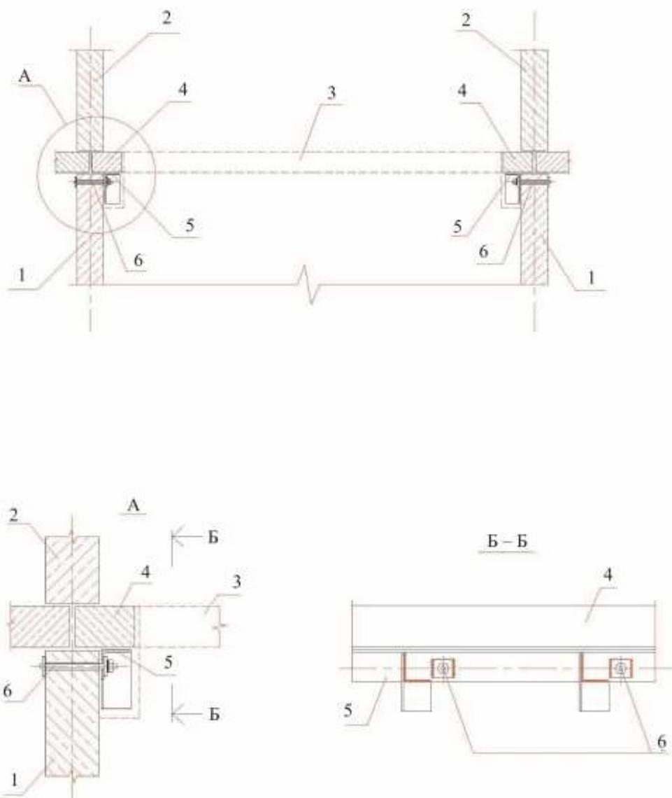
1, 2 – панели внутренних несущих стен; 3 – вырезаемая часть плиты перекрытия; 4 – остающиеся опорные участки плиты перекрытия; 5 – подкрепляющая конструкция из L100×100×6,5; 6 – стяжные болты M16 с шайбами 65×65×10 через 600 мм
