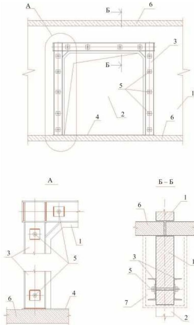
1 – панель внутренней несущей стены; 2 – проем; 3 – стальная рама из швеллера № 22; 4 – затяжка из полосы сечением 90×10; 5 – болты стяжные М16 с анкерными шайбами 100×100×10; 6 – плиты перекрытия; 7 – обетонировка
