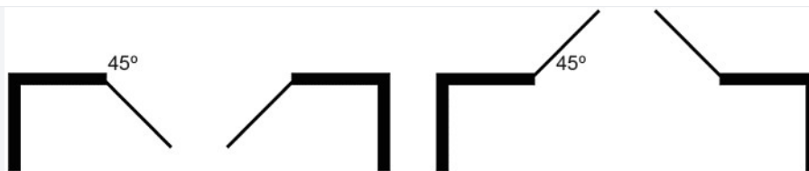
Рисунок 33 - Дверной проем с двустворчатыми дверными полотнами
