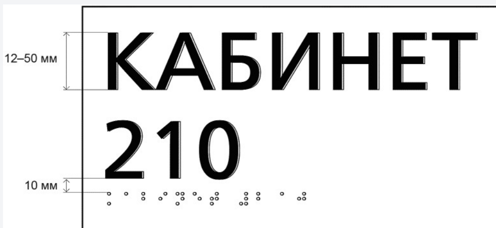
Рисунок 2 - Высота РЛШ при совмещении визуальной и тактильной информации (в данном случае знаки РТШ рекомендуется выполнять прозрачными или в цвет подложки)
