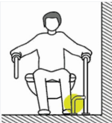
Рисунок А.17 - Опора поручня, создающая помеху при вставании
