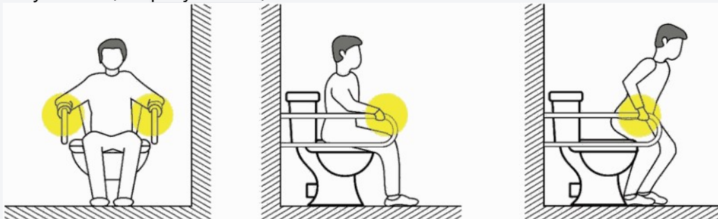
Рисунок А.6 - Использование выступающей за передний край унитаза части горизонтального поручня при вставании с унитаза
